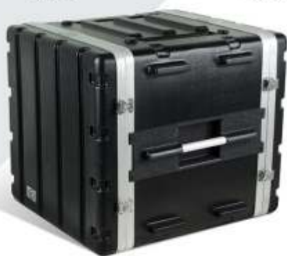
8U Case para periféricos em ABS padrão rack 19" com perfil de alumínio. Dimensões (AxLxP): 39x48x54cm
